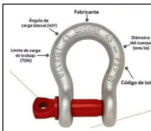
Figura 23. Especificaciones en grilletes
