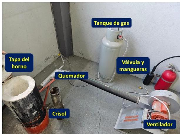
Figura 1. Horno de fundición a Gas LP. Fuente: Elaboración propia.
