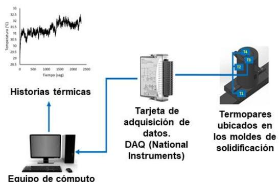
Figura 5. Esquema de adquisición de datos para los valores de las temperaturas en los moldes de solidificación. Fuente: Elaboración propia.
