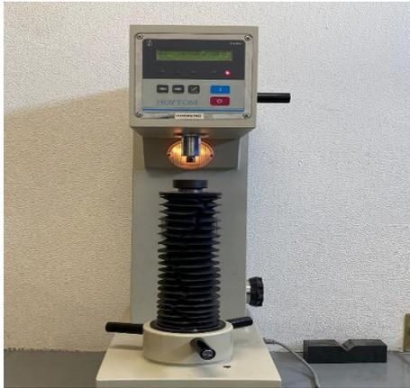
Figura 10. Durómetro Hoytom Super Rockwell - Duplex 713-SR. Fuente: Elaboración propia.
