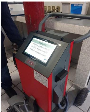
Figura 8. Espectrómetro tipo SPECTROPORT empleado para determinar composición química en los punzones. Fuente: Elaboración propia.
