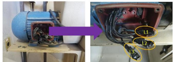
Figura 5. Conexión del motor a 220 V. Fuente: Elaboración propia.
