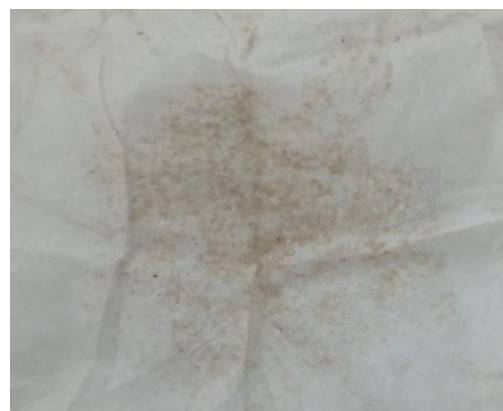
Figura 2. Filtro con muestra de micropásticos.
