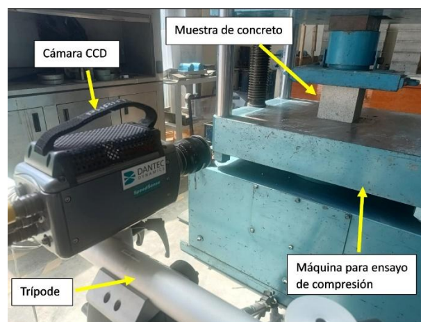
Figura 2: Arreglo experimental del ensayo de compresión.
