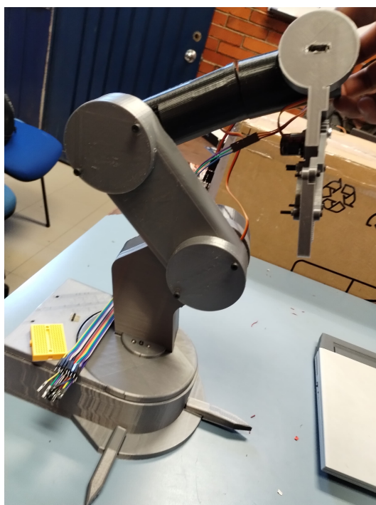
Figura 15: Ensamble final del prototipo del robot antropomórfico de 5 GDL.
