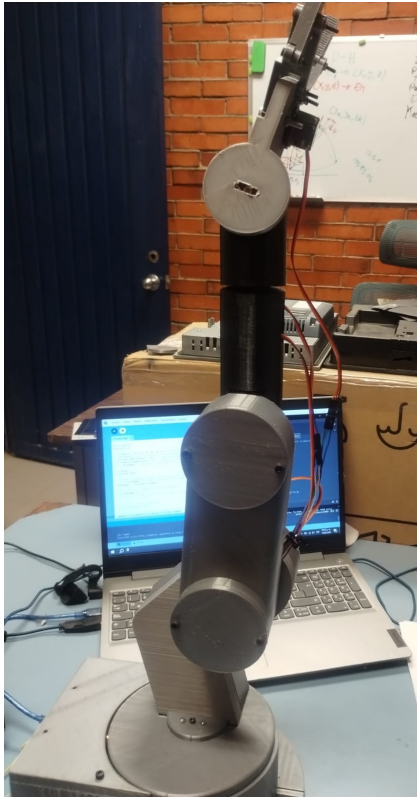
Figura 16: Ensamble final del prototipo del robot antropomórfico de 5 GDL en su máximo alcance.
