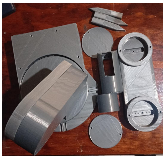
Figura 13: Impresión en PETG de la base, eslabones 1, 2, 3 y 4 del robot antropomórfico
