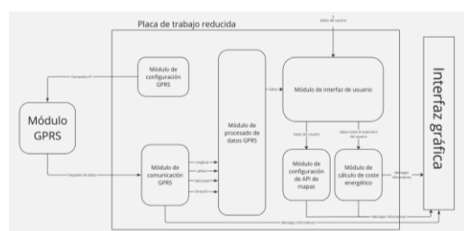
Figura 3. Arquitectura final del sistema de navegación GPS para autos eléctricos (elaboración propia).
