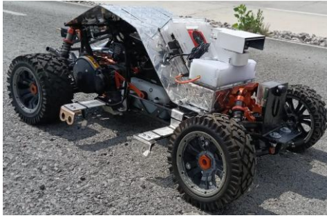
Figura 2. Vehículo a escala 1:5 con sistema embebido incorporado.
