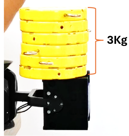
Figura 13: Prueba mecánica del cople, donde se colocó un peso de 3kg.
