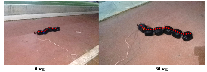
Figura 18: Robot serpiente realizando la locomoción en serpentina sobre una superficie con hormigón rojo que funciona como pista de atletismo.
