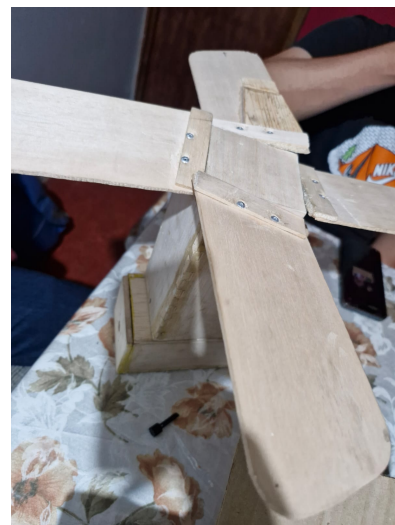
Figura 24: CanSat en estado de reposo con el sistema de autogiro desplegado.
