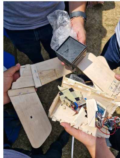
Figura 27: Estado del CanSat tras el impacto. Se observa fractura del autogiro y apertura de la estructura para inspección interna.
