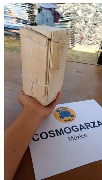
Figura 25: CanSat con el sistema cerrado y el contenedor principal ensamblado antes de las pruebas.
