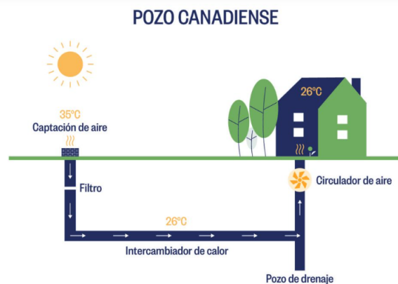
Figura 5: Componentes de un sistema de pozos Canadienses (ECONOVA, 2022).
