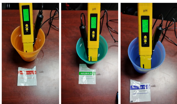
Figura A.9: Ajuste y calibración de sensor de pH con soluciones de referencia.
