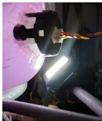
Figura C.12: Sensor de turbidez y lámpara.
