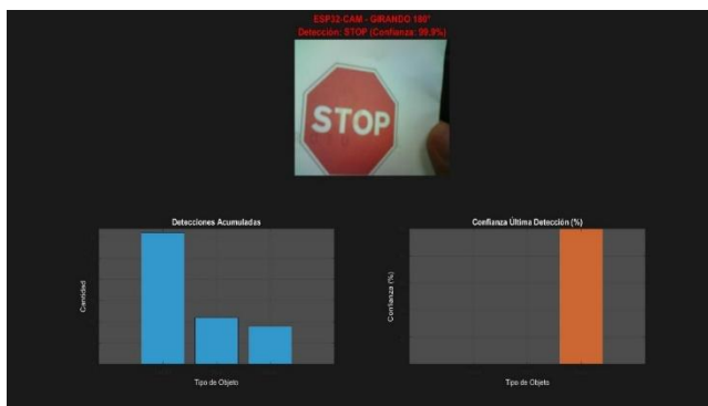
Figura 14. Interfaz de detección en tiempo real. Se muestra el stop capturado. El sistema clasifica correctamente la escena como "Stop", lo cual se refleja en las gráficas de confianza.
