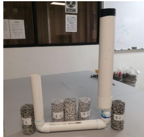
Figura 4: Permeámetro de carga variable para la obtención del gasto promedio en especímenes de concreto permeable con adición de fibras de acero.
