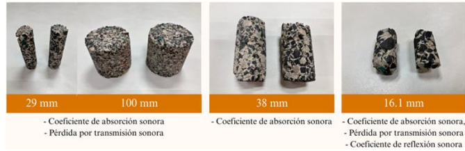
Figura 3. Probetas obtenidas de los tabicones con adiciones de Noryl, para la evaluación del comportamiento acústico del material a través de diferentes tubos de impedancia.
