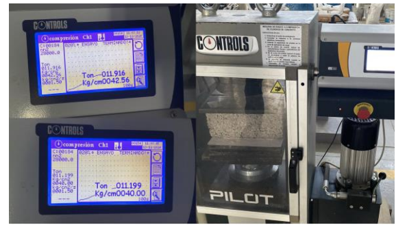
Figura 4. Pruebas de resistencia mecánica a los tabicones modificados.
