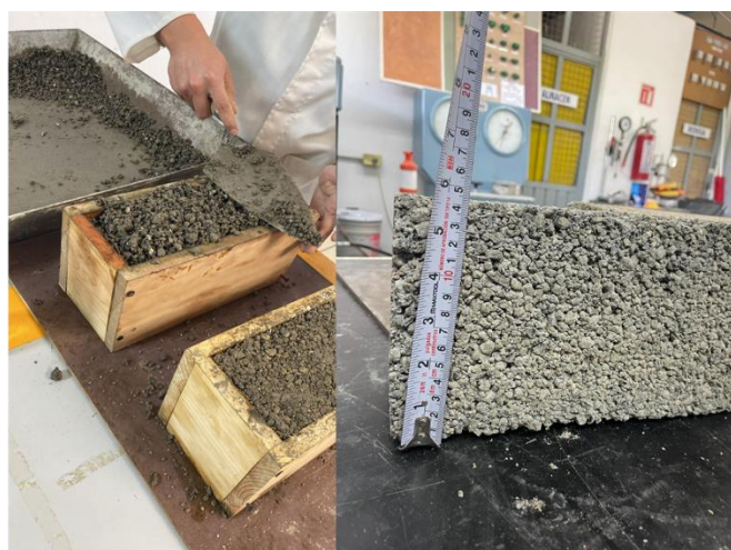
Figura 1. Tabicones con 20% y 57% de sustitución de agregados pétreos por Noryl.
