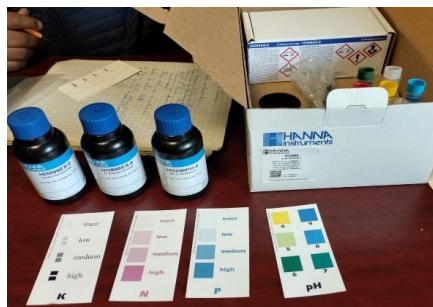
Figura 8. *Kit HI3896 de HANNA Instruments (análisis semicuantitativo). Fuente: Elaboración propia.
