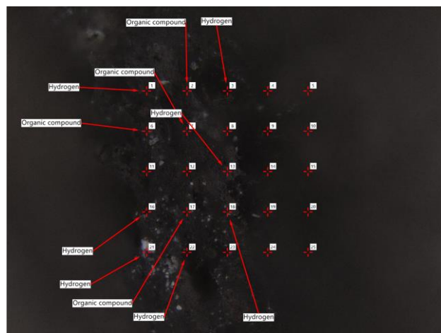
Figura 7: Imagen obtenida por Espectroscopía de Plasma Inducido por Láser, mostrando puntos con altas concentraciones de carbono e hidrógeno, confirmando la localización del caucho dentro del concreto.
