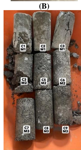
Figura 1. (A) Resultados de la resistencia a la compresión según el porcentaje de caucho, (B) máquina de compresión una prensa hidráulica marca Controls y (C) evidencia de cilindros evaluados en la máquina de compresión por triplicado, a 14 días de curado.
