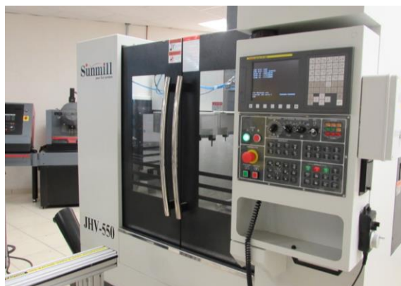
Figura 1: Fresadora CNC Sunmill modelo JHV-550 utilizada en la experimentación. Fuente: Elaboración propia.
