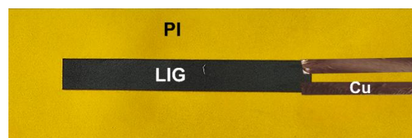
Figura 3. Conexión de terminales de Cu sobre el patrón rectangular de LIG.
