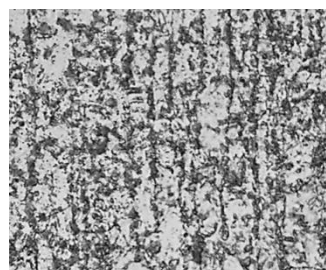
Figura 4. Microestructura del acero DP780 en condición de recibido.
