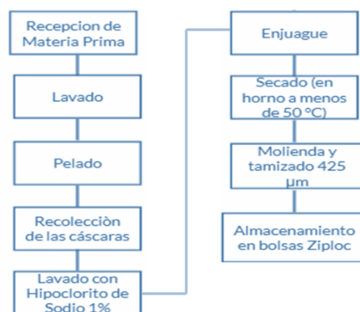
Figura 1. Preparación de las cáscaras de plátano. Este diagrama resume las etapas fundamentales del procesamiento de materia prima: evaluación inicial; lavado, pelado y recolección de cáscaras; desinfección con hipoclorito de sodio 1%, enjuague y secado a 50°C hasta cumplir con un valor de humedad
