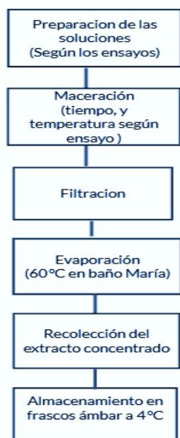
Figura 2. Método de maceración con calor. El proceso integra: preparación de soluciones según ensayos; ajuste de tiempo y temperatura por ensayo; filtración para eliminar sólidos; evaporación en baño María a 60^\circ\text{C} para concentrar el extracto; recolección del extracto concentrado; y almacenamiento en frascos ámbar a 4^\circ\text{C} .
