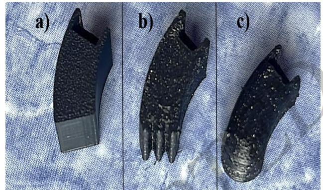
Figura 9: Prototipos de yemas impresas en 3D con distintas geometrías. a) Yema Plana. b) Yema Piramidal. c) Yema Redonda.
