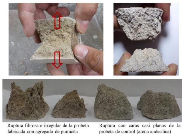
Figura 12. Formas características de la ruptura a tracción de las probetas ensayadas, a la izquierda la muestra de pumicita y a la derecha la de control.
