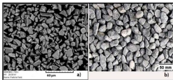
Figura 1: Comparación de geometría y similitud de alúmina y grava. a) muestra una micrografía de alúmina con un aumento de 750 \times ; b) muestra una fotografía a tamaño real de la piedra de grava; ambas partes presentan similitud en su geometría amorfa (De la Mora, 2023).
