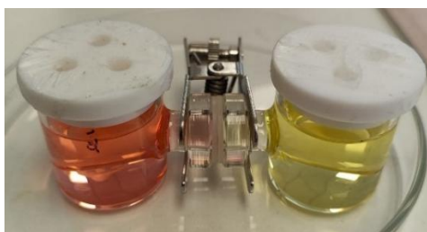
Figura 1: Celda de difusión empleada en este trabajo, del lado derecho la solución donante, del lado izquierdo la solución receptora.
