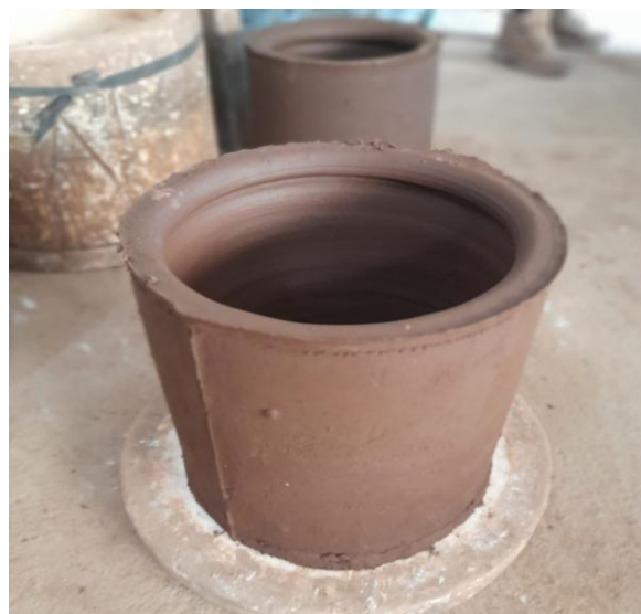
Figura 5. Maceta de arcilla. La incorporación de lodos residuales puede contribuir al mejoramiento de la manejabilidad en su manufactura, así como de la calidad final en el proceso de cocción.
