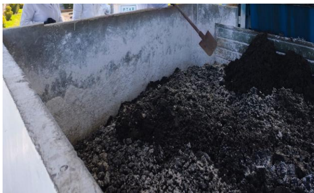
Figura 1. Lodos de PTAR, con tratamiento primario a partir de la incorporación de hidróxido de calcio (cal).
