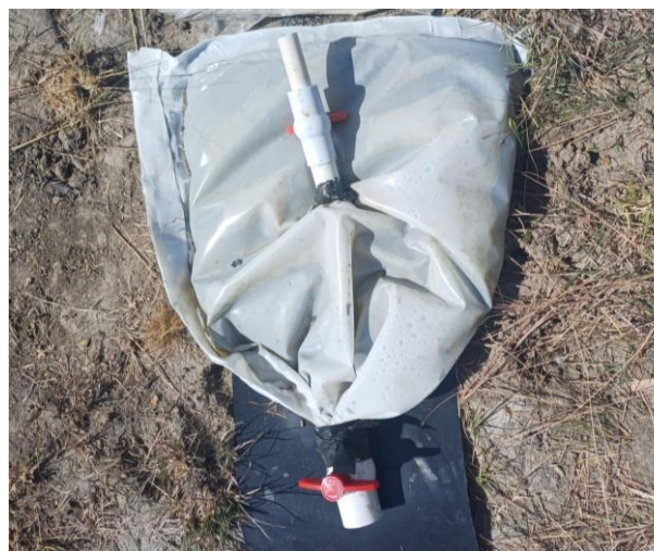
Figura 7. Biorreactor experimental tipo bolsa para tratamiento de lodos residuales. El reactor permite obtener biogás a partir de la digestión anaerobia de la materia orgánica presente en los lodos.
