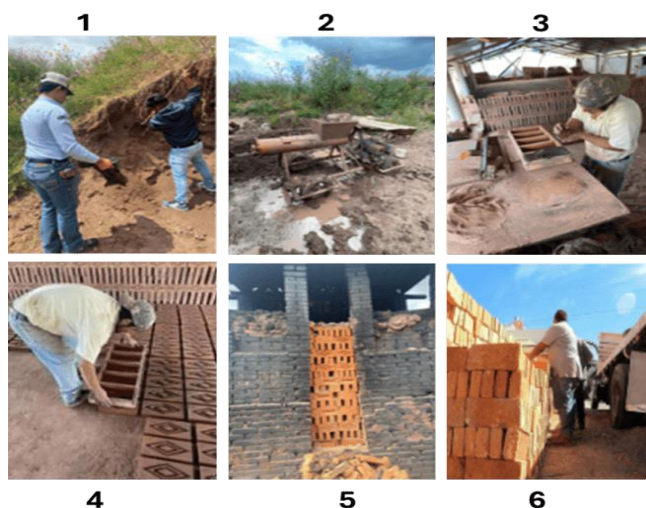
Figura 1. Etapas del proceso de producción de ladrillo rojo
