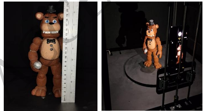
Figura 8. Estatura y vista del proceso de captura de imágenes en plataforma modular XY en laboratorio oscuro de un modelo genérico tridimensional animatrónico utilizado para pruebas de fotogrametría.
