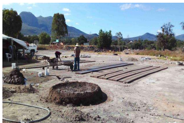
Figura 7. Vista general de un patio con soquetera, presa y área de labrado Fuente. Ladrillera Don José, El Arenal, Hidalgo. Galindo Escamilla, 2023.
