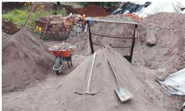
Figura 3. Herramientas manuales para la selección y transporte de materias primas en los patios Fuente: Ladrillera Don Sergio, El Arenal, Hidalgo. Galindo Escamilla, 2023.
