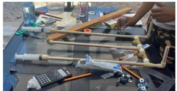
Figura 3. Fotografía de estudiantes construyendo un mecanismo de movimiento real basado en la bomba de Ctesibio
