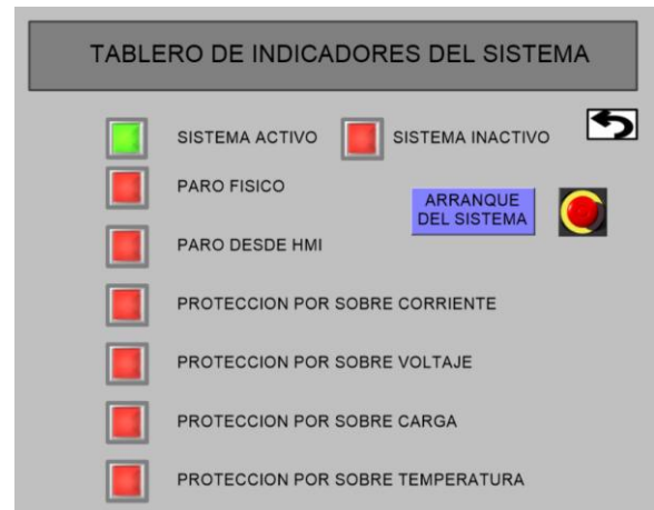
Figura 8. Vista del panel de control y gestión de alarmas en la HMI. Permite supervisar el estado del sistema y recibir notificaciones inmediatas ante fallas, facilitando una respuesta rápida del operador o acciones automáticas. Elaboración propia.
