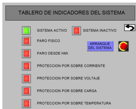
Figura 8. Vista del panel de control y gestión de alarmas en la HMI. Permite supervisar el estado del sistema y recibir notificaciones inmediatas ante fallas, facilitando una respuesta rápida del operador o acciones automáticas. Elaboración propia.
