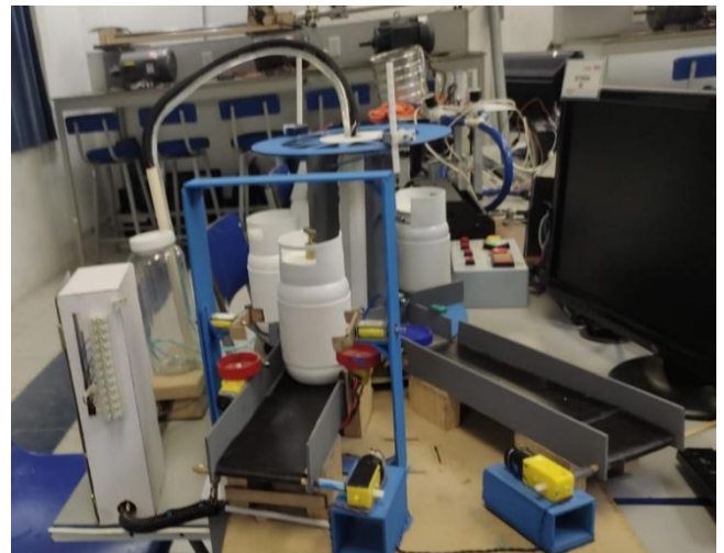
Figura 11. Modelo tecnológico a nivel laboratorio del sistema de llenado tipo carrusel, mostrando la integración de los mecanismos, sensores y actuadores con el PAC RX3i .
