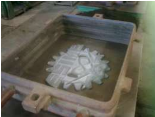
Figura 2.-Colocación del modelo dentro de la caja de moldeo centrándolo y espolvoreando con polvo separador.
