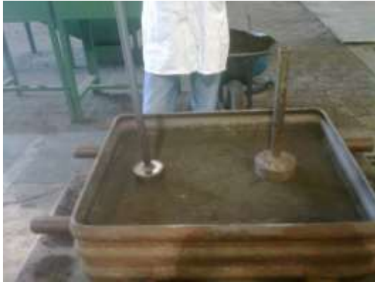
Figura 6.-Se compacta nuevamente la arena, como en la primera.
