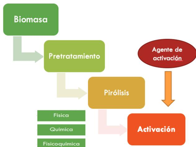
Figura 4. Esquema metodológico general para la obtención de carbones activados.
