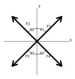
Figura 9. Fuerzas con ángulos medidos tomando como referencia el eje Y
