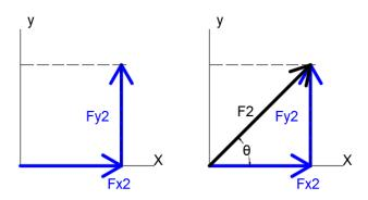
Figura 5. Movimiento de Figura 6. Trazo de fuerza resultante F2 y ángulo
