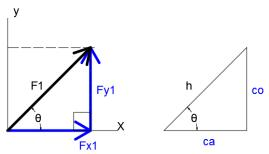
Figura 3. Comparación de triangulo de fuerzas con triangulo rectángulo.
