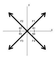
Figura 8. Fuerzas con ángulos medidos tomando como referencia el eje x
