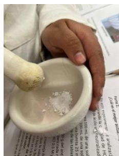
Figura 2. Trituración de tableta en mortero
