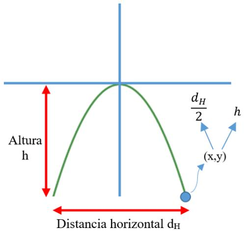
Figura 1. Definición de una coordenada (x,y) relacionada con la distancia horizontal y la altura
