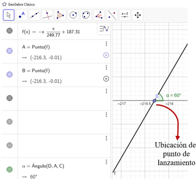
Figura 4: Uso del software de GeoGebra para determinar gráficamente la ubicación precisa del punto de lanzamiento del proyectil a partir de su ecuación a partir de una recta tangente
