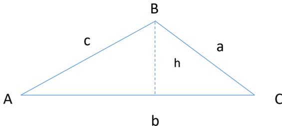
Figura 1: se observa que el trazo de la altura en el triángulo oblicuángulo genera dos triángulos rectángulos.
