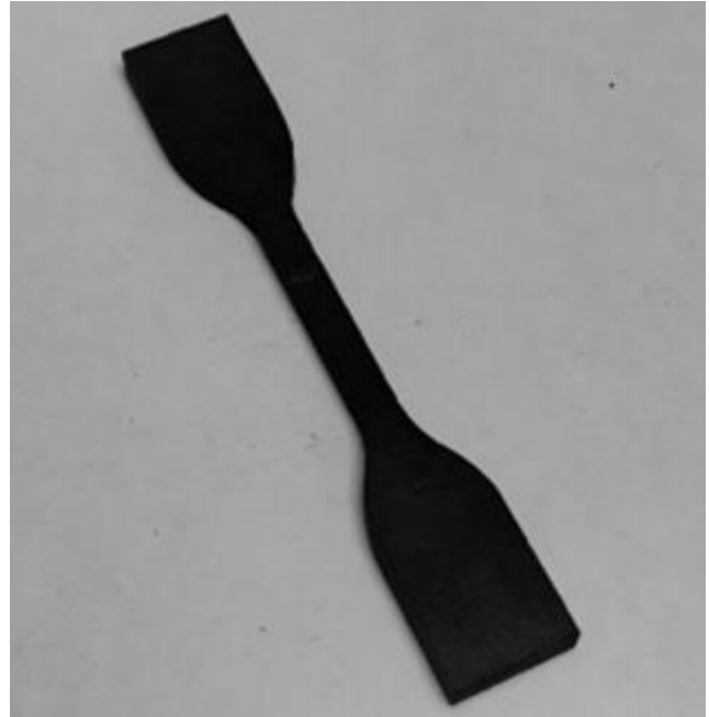
Figura 5. Probeta plana tipo I para ensayo mecánico a la tensión. Fuente: elaboración propia.
