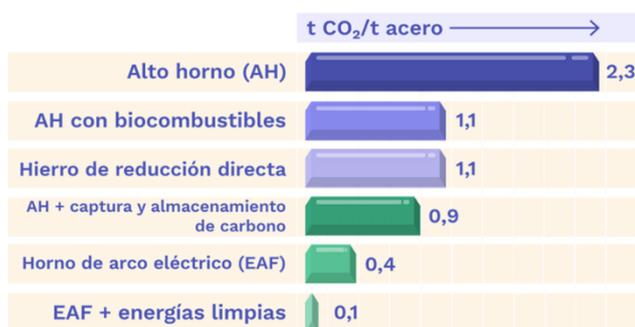
Figura 11. Intensidad de CO<sub>2</sub> de diferentes tipos de producción de acero.
