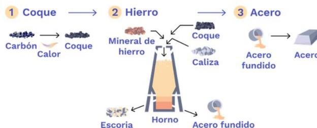
Figura 5. Proceso de fabricación del acero.
