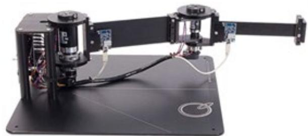
Figura 1. Robot serial de dos grados de libertad. Fuente: Elaboración propia.
