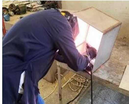
Figura 4. Soldadura de los depósitos para el líquido refrigerante. Fuente: Elaboración propia.
