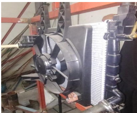
Figura 3. Radiador y ventilador acoplados en la estructura. Fuente: Elaboración propia.
