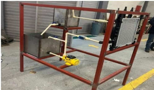
Figura 8. Sistema de enfriamiento terminado. Fuente: Elaboración propia.
