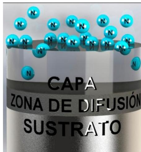
Figura 1. Esquema de la difusión del nitrógeno al interior del material.
