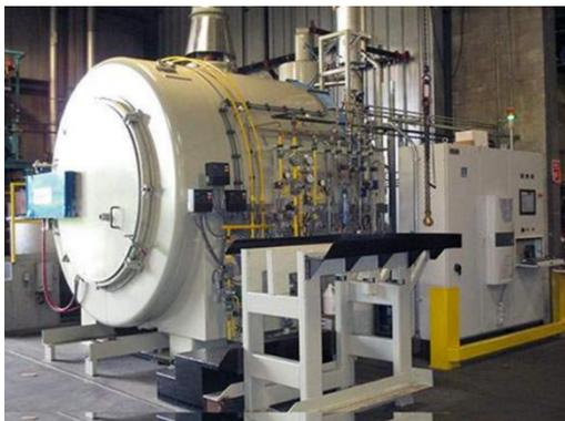
Figura 6. Reactor de nitruración por gaseosa (Cambridge Heat Treating Inc, s.f.).
