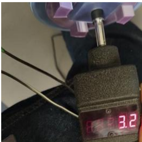
Figura 6. Medición de velocidad angular o revoluciones por minuto con tacómetro. Fuente: Elaboración propia.
