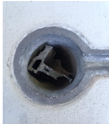
Figura 4. Carga metálica en el interior del crisol del horno. Fuente: Elaboración propia.
