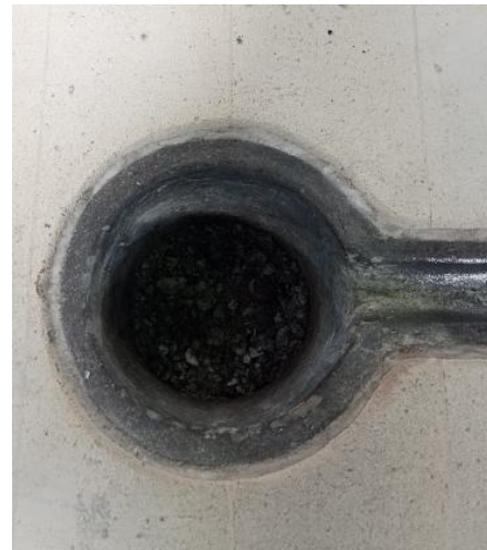
Figura 5. Baño metálico al interior del crisol del horno. Fuente: Elaboración propia.
