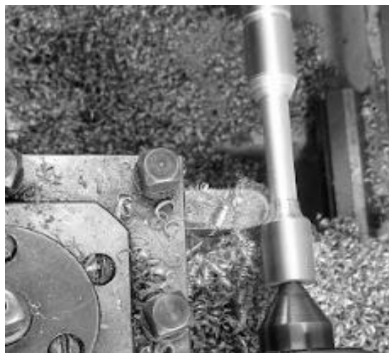
Figura 8. Mecanizado de probetas en torno paralelo. Fuente: Elaboración propia.
