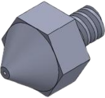
Figura 4. Modelo de la boquilla M6 con barreno de 0.4 mm de diámetro interior. Vista isométrica. Fuente: Elaboración propia
