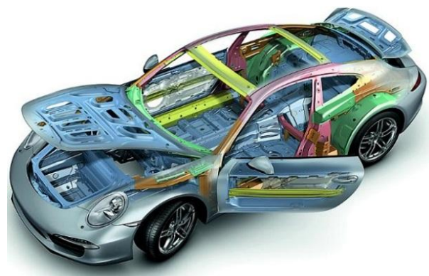
Figura 4. Carrocería y chasis de un automóvil. Fuente: Elaboración propia.
