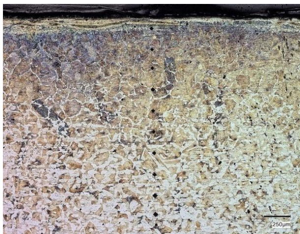
Figura 3: Indentaciones del acero 1018 a 1100°C (250X), con el microscopio digital VHX-7000 KEYENCE
