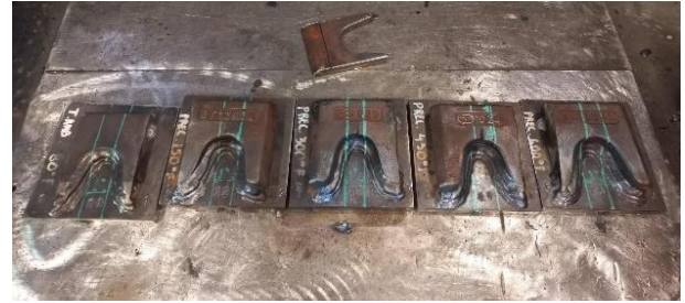
Figura 3. Muestras soldadas a diferentes temperaturas de precalentamiento. Fuente: autores.
